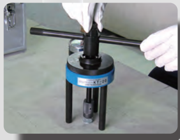
② アンカーにカップリングをねじ込む
