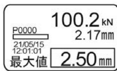
荷重-変位試験モード
