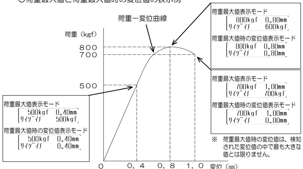
荷重最大値および荷重最大値時の変位値をクリアするには、荷重最大値表示モードまたは荷重最大値時の変位値表示モードで【最大値クリア】ボタンを押してください。
